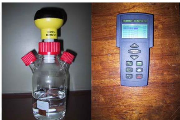
Abb. 1: links: Reaktionsgefäß (WTW-Oxiotop-Flasche) mit Druckmesskopf (gelb). Rechts Controller zur Messwertübertragung.
